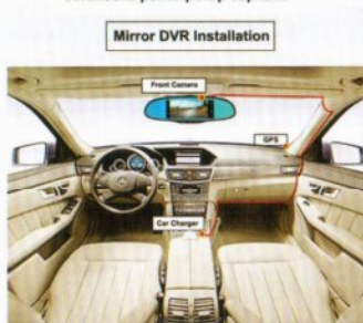
Рисунок 16: Схема подключения проводов регистратора
