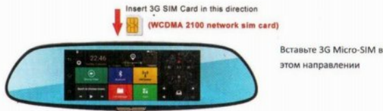
Рисунок 17: установка Micro-Sim карты
